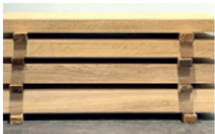
Exemple de stockage avec des tasseaux entre chaque panneau pour une meilleure ventilation
